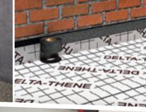
3. На переходе от стены к фундаментной плите нужно выполнить галтель, например, из цементно-песчаного раствора 4, 5. Гидроизоляция пола
